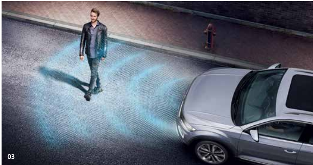
03 보행자 모니터링 시스템 전방 카메라 및 레이더 센서를 통해 도로 주변의 보행자를 감지하고 충돌이 예상되는 경우 시청각적인 경고와 제동 보조 혹은 긴급 제동을 통해 사고 발생 가능성 혹은 사고의 심각성을 경감시켜주는 기능입니다.
